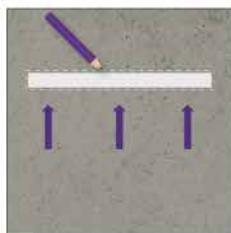
**3.** Presenta el desagüe y marca el contorno en la superficie donde realizarás la instalación. Retira y deja en un lugar seguro la tapa para evitar posibles daños o rayaduras. La profundidad mínima de la canaleta debería ser de 80 mm.
