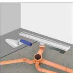
**8.** Extiende la mezcla de concreto hasta llegar a la base del desagüe, creando una inclinación de mínimo 2% por metro lineal en dirección a donde se instalará. Si deseas, coloca una membrana impermeabilizante siguiendo las instrucciones del fabricante.
