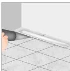
**12.** Aplica sellador de silicona en el perímetro del desagüe, cubriendo bien la junta. Sella la unión entre éste y el suelo con silicona impermeable. Evita circular fluidos (cloros, ácidos y sales en grandes concentraciones) que puedan dañar el producto.
