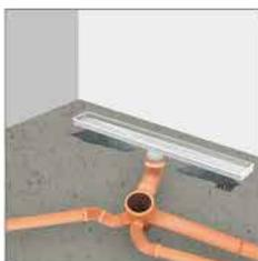
**6.** Vierte la mezcla de mortero debajo de la base del desagüe para dar soporte y fijar la nivelación.
