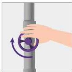
**2.** Cierra la abertura de evacuación del desagüe antes de su montaje para evitar que la suciedad producida durante las obras se introduzca en el conducto.
