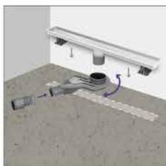
**4.3.** Para la instalación de cañería de 50 mm, utiliza el adaptador 40/50 mm en la salida del sifón. De lo contrario, si la cañería de desagote del hogar es de 40 mm, no colocar el acople de salida del sifón.
