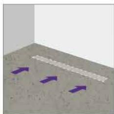
**1.** Determina el lugar donde será instalado el desagüe Lineal Aqua. La posición en el box de ducha puede ser en el sector posterior, al frente o en el centro.
