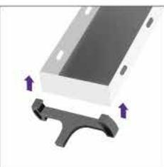
**10.** En caso de contar con un modelo 2 en 1, elige entre la tapa lisa o puedes invertirla y colocar en su interior el cerámico. Para ello, retira los sujetadores plásticos de la tapa utilizando la llave y colócalos en el lado opuesto de la misma; asegúrate que queden fijados correctamente. Para instalar el revestimiento, aplica una capa de mortero dentro del marco de la tapa para que el cerámico quede al ras.
