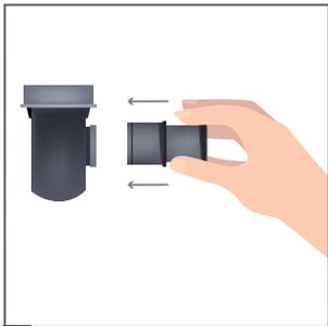
**5.** En caso de ser necesario, conecta el adaptador DM40/50 a la boca de salida e insértalo profundamente para asegurar que el O ring retenga cualquier intento de filtración de agua.
