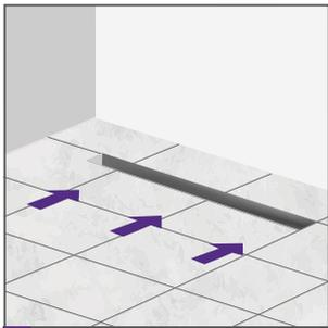
**1.** Determina el lugar donde será instalado el desagüe/coladera lineal. La posición en el box de ducha puede ser en el sector posterior, al frente o en el centro.
