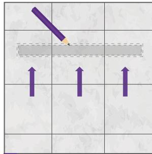
**3.** Presenta la canaleta y marca el contorno del desagüe en la superficie donde hará la instalación. La profundidad de la canaleta es de 3-3/8" (85 mm).
