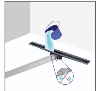
**8.** Realiza una prueba de estanqueidad vertiendo agua en la canaleta y verifica que el drenaje fluya.
