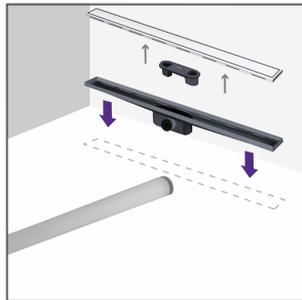
**6.** Conecta los caños de la red de desagüe al desagüe lineal utilizando pegamento en la conexión.
