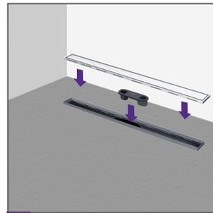
**10.** Coloca el sifón interno y la tapa del desagüe.
